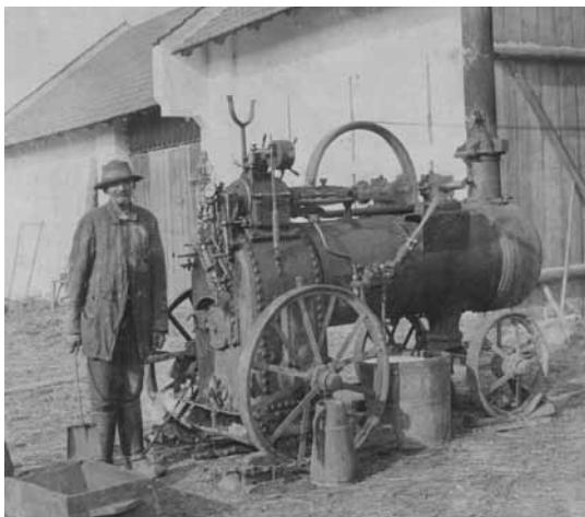
Tzv. lokomobila v Kapplově dvoře sloužila především k mláčení snopů po žních, kolem r. 1905
